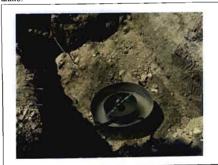
Figura 5.3.- Detalle del sistema de medición de la capacidad de infiltración mediante infiltrometría de doble anillo.
